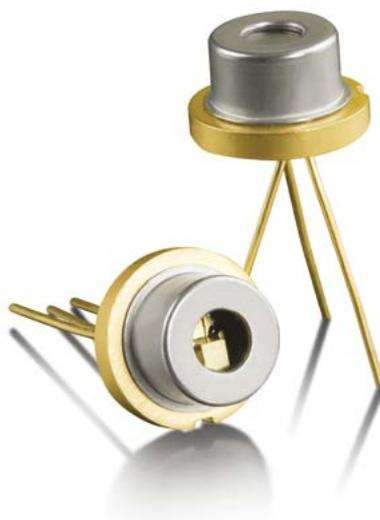
Ceci est assuré par l'angle de divergence de 8°x17°, petit pour une diode laser. Le ADL-85Y51TL est intéressant pour une utilisation dans de nombreuses industries (par exemple, pour la mesure de distance par laser, la technologie des capteurs et la reconnaissance faciale). Il ouvre également de nouveaux champs d'application en médecine esthétique et en thérapie photodynamique. ■
