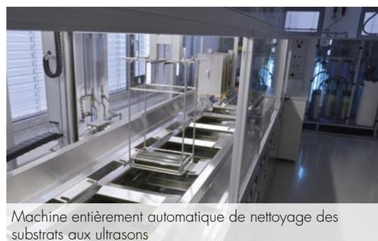
Machine entièrement automatique de nettoyage des substrats aux ultrasons
